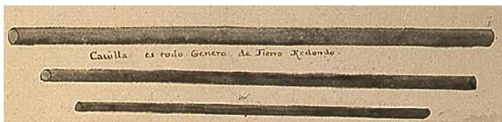
Figura 3. Cabillas de hierro redondas. Fragmento de la lámina No. 51 del Álbum de Construcción Naval del Marqués de la Victoria (1756). Fuente: España, Ministerio de Defensa, AMNM.
